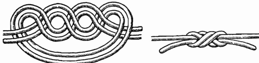
Рис. 22. Водяной узел
